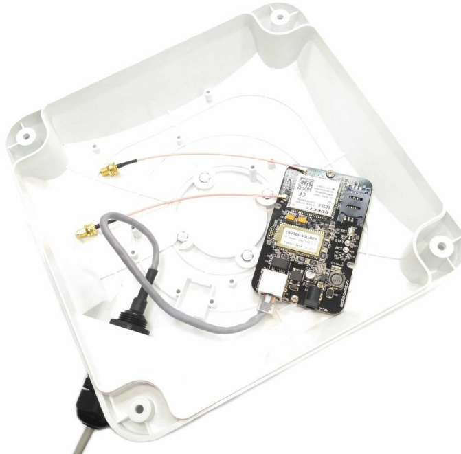
Рис.3.2. Пример монтажа Tandem-4GL-OEM в герметичную антенну Antex Unibox
