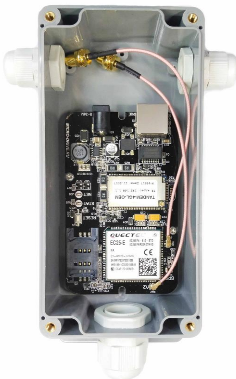
Рис.3.3. Пример монтажа Tandem-4GL-OEM в гермобоксы «Gainta»
